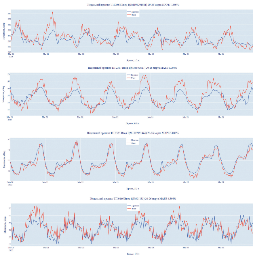
Рис. 10. Недельные прогнозы реактивной мощности трансформаторов ТП
